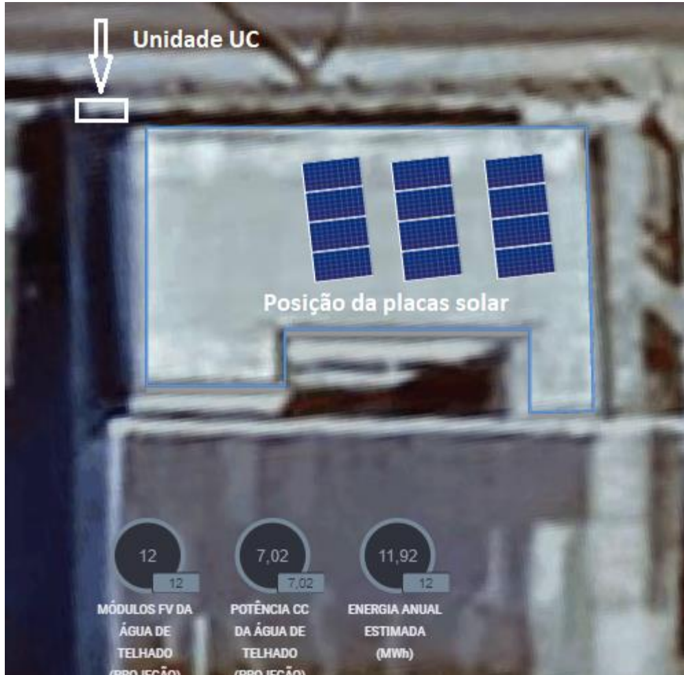
Figura. 1.1 - Localização das placas em cima do telhado.
